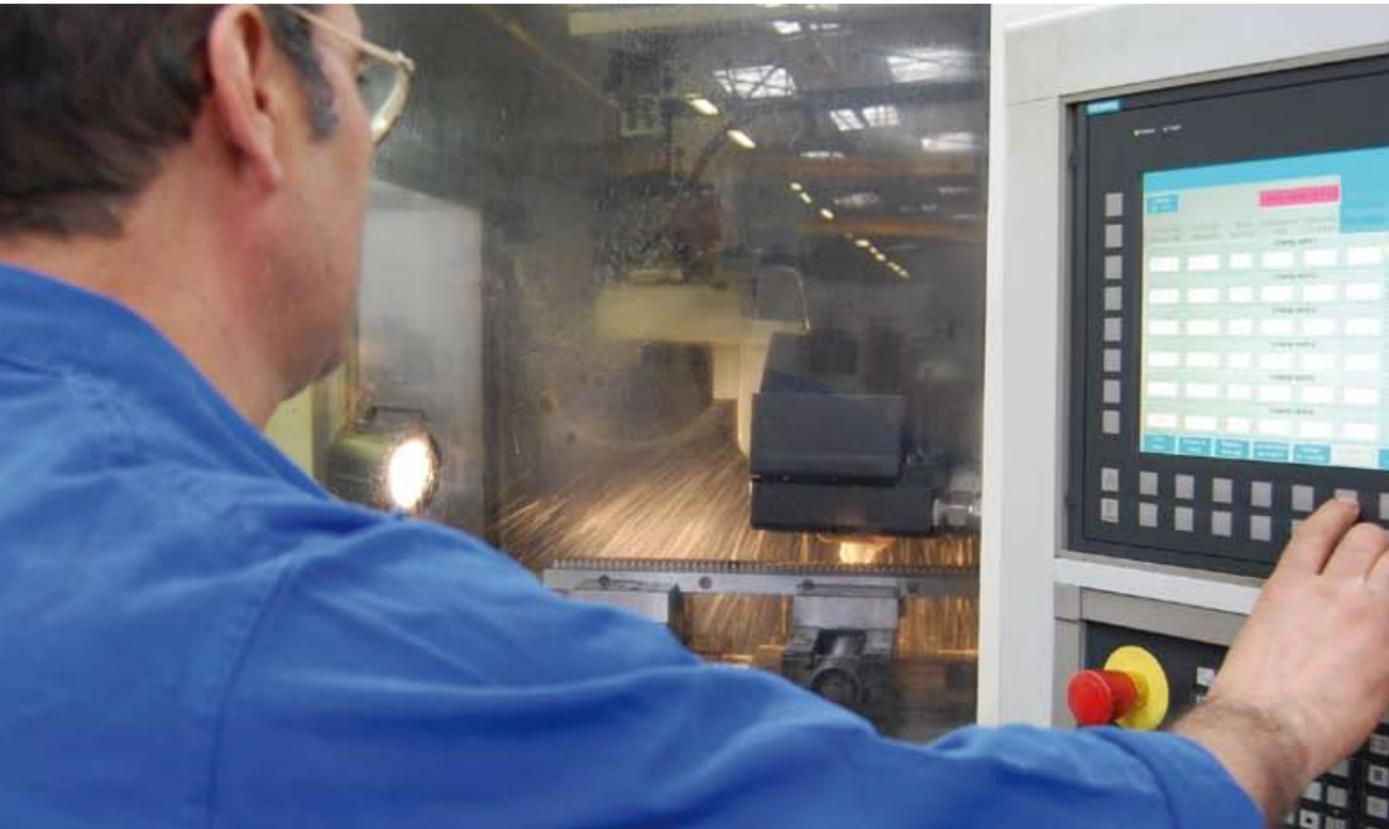
Rectifieuse de denture. Denture rectifiée disponible sur les gammes PLATINIUM et CARAT et pour les crémaillères sur mesure.
